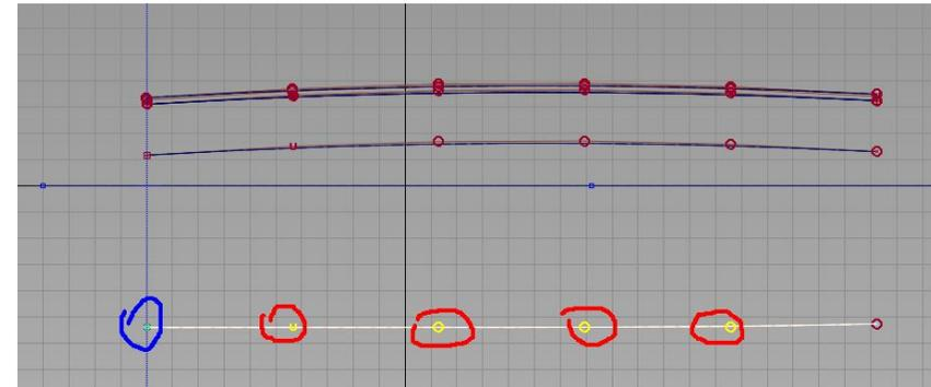
copy边上那条曲线，2份，拖到，如图，差不多合适位置，将下面一条曲线，中间的几个cv点，与边上的cv点，进行一条直线操作，（前面讲过）做出图3，边上一条曲线。
