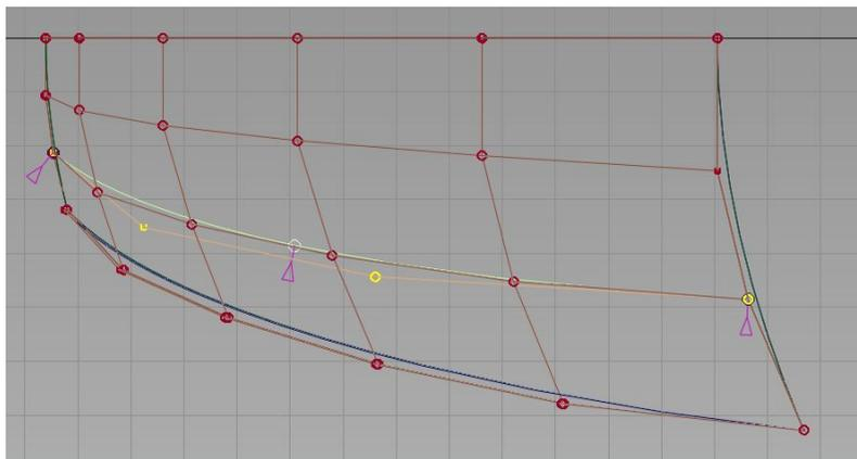
过如图2个面上的cv点，做一条2或3阶的曲线。这2点，位置不是绝对的，大家可以根据需要确定这2点的位置，我这里是为了方便。做好后，使用stretch curve工具调整曲线曲率，使之于面上的那条hull有差不多的曲率即可以。做好面后，再看看这块面的边上于上边那条曲线的落差，是不是能满足你最后的需要，如果不行，这时只要对曲线进行相应的调整即可以。自己控制好需要的落差。
